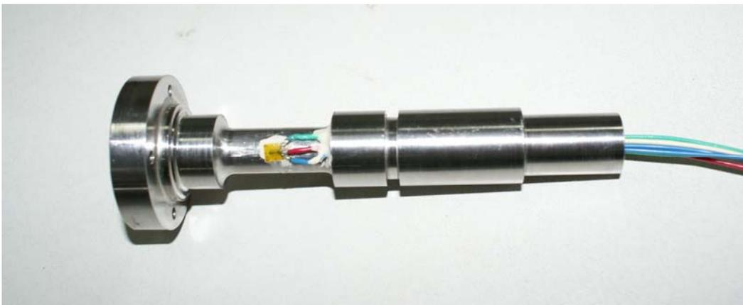
图 1 用于测量水轮机模型导叶水力矩的特制导叶轴
