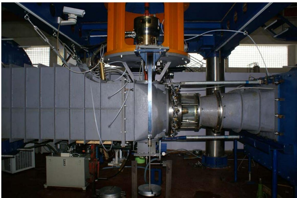
图 2 灯泡贯流式水轮机模型
